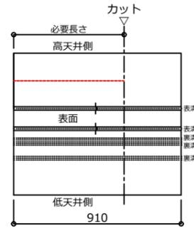
②カットしたボードのV溝に白ボンドを溝のラインに沿って注入する
